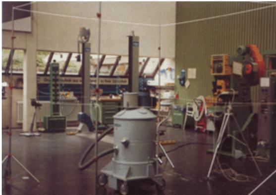
**Bild 5-2: Geräuschemissionsmessung an einem Industriestaubsauger. Die vier aufgestellten Stative legen die Hüllflächen fest**
