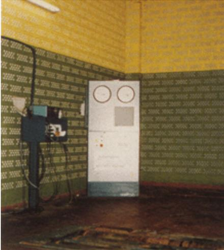
**Bild 6-39:** Leistungsprüfstand für Pkws mit absorbierenden Wänden aus Lochziegeln
