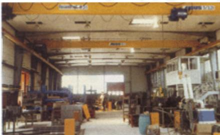
**Bild 6-41:** Raumakustisch günstig gestaltete Werkhalle eines Metall verarbeitendes Betriebes. Mineralwolleplatten als Akustikdecke. Die freien Wandflächen bestehen z. T. aus Lochziegeln mit hinterlegter Mineralwolle
