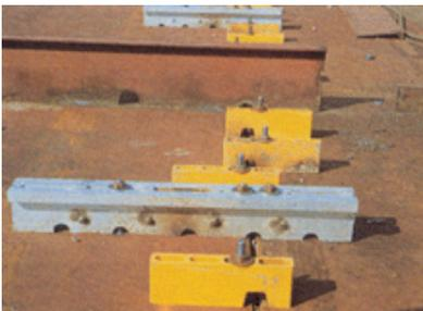
**Bild 6-9: Bolzenschweißen bei der Plattenstoßmontage im Schiffbau. Dieses Verfahren ersetzt das Anschweißen von z.B. Knacken, die später mit erheblichem Lärm abgetrennt werden müssen. Senkung des Beurteilungspegels um ca. 10 dB(A)**
