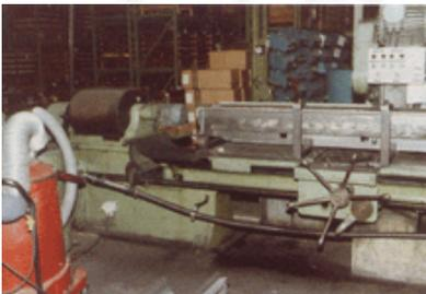
**Bild 6-8: Absaugen von Guss-Spänen an einer Fräsmaschine. Ursprünglich wurden die Späne abgeblasen. Pegelminderung von 95 auf 83 dB(A)**
