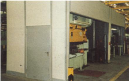
**Bild 6-32: Abgeschirmte Gesenkbiegepresse; über den Abschirmwänden befinden sich zylinderförmige Absorber**
