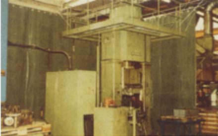
**Bild 6-31: Beweglicher Schallschutzvorhang an zwei Seiten einer Spindelschlagpresse. Dieser Schallschutzvorhang ist auf der Seite der Presse absorbierend ausgeführt**
