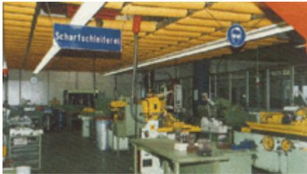
**Bild 6-43: Walzenförmige Absorber in einer Werkzeugschleiferei. Staubablagerungen auf den Absorbern müssen gegebenenfalls entfernt werden**
