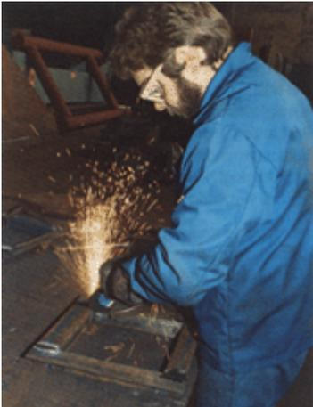
**Bild 8-7: Das Benutzen von Gehörschutzstöpseln erleichtert diesem Mitarbeiter das Tragen der Schutzbrille. Kapselgehörschützer wären hier problematischer**
