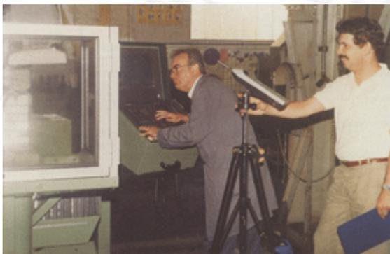
**Bild 3-4: Geräuschimmissionsmessung; gemessen wird hier in Ohrnähe des Beschäftigten**
