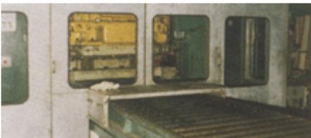
**Bild 6-26:** Die Öffnung für die Materialzufuhr wurde bei dieser voll gekapselten Presse als Schalldämpferstrecke ausgebildet
