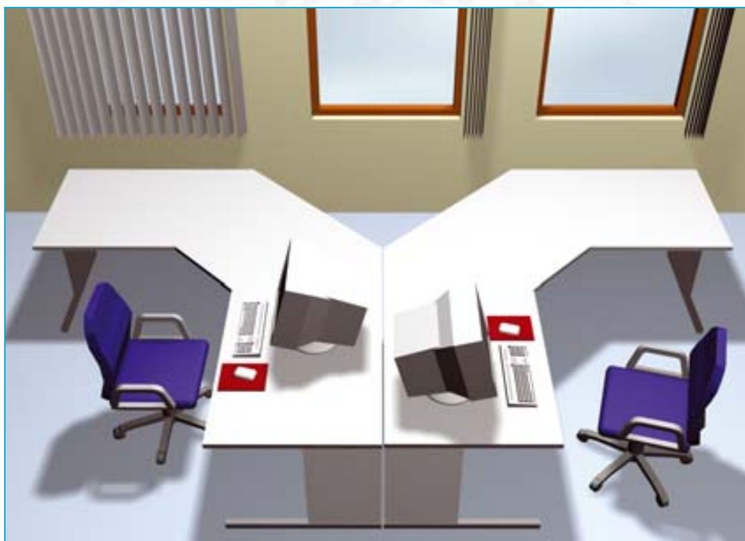
Abbildung 64: Anordnung der Bildschirmarbeitsplätze sowie Sonnenschutzvorrichtungen zur Begrenzung der Blendung durch Tageslicht
