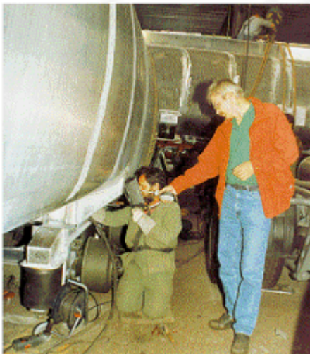
Bild 5-4: Personenbezogene Messung mit PAS für die Ermittlung partikelförmiger Schadstoffe
