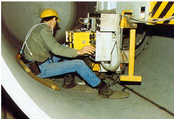
Bild 9-2: Unterpulverschweißen, ein schadstoffarmes Verfahren
