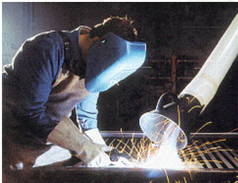
Bild 9-6: Metall-Schutzgasschweißen (MIG/MAG) mit Absaugung
