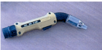
Bild 9-9: Brenner mit integrierter Absaugung
