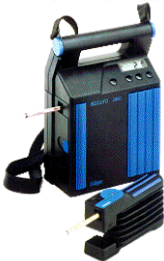
Bild 5-2: Direktanzeigende Prüfröhrchen; Einhandgasspürpumpe und Pumpautomat accuro 2000 mit Prüfröhrchen für die Messung von gasförmigen Schadstoffen
