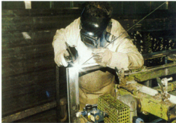
Bild 9-1: WIG-Schweißen, ein schweißraucharmes Verfahren
