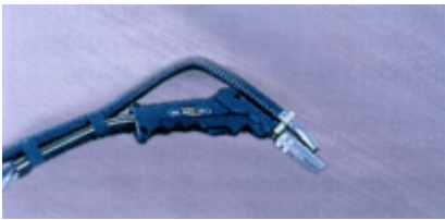
Bild 9-8: Erfassungselement am Brenner befestigt
