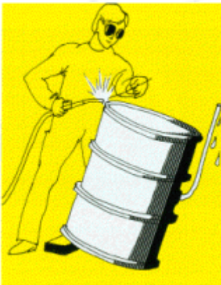
Bild 17-7: Arbeitstechnik beim Schweißen an Fässern oder ähnlichen Gefäßen
