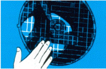
Bild 10-2: Mit Maschendraht gesicherter Ventilator
