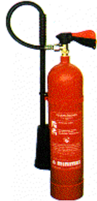
DIN EN 3 – Kohlendioxidlöscher , z.B. 5 kg Inhalt bei der Brandklasse B mit innen- liegendem Steigrohr, Druckhebel, Hochdruckschlauch und abstellbarer Löschbrause
