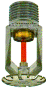
Bild 12-29: Sprinkler, Kennfarbe rot, Auslösetemperatur 68 °C
