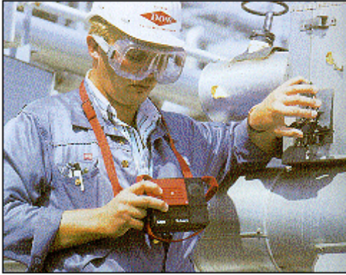
Bild 12-9: Einsatz eines Gasmessgerätes
