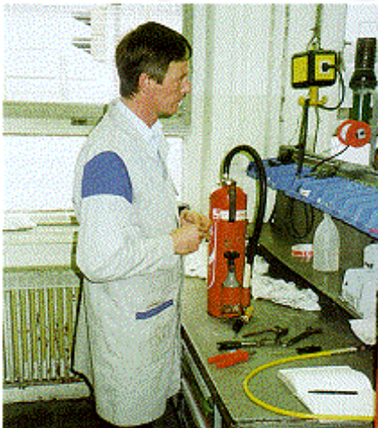
Bild 12-25: Prüfen eines Pulver-Aufladelöschers
