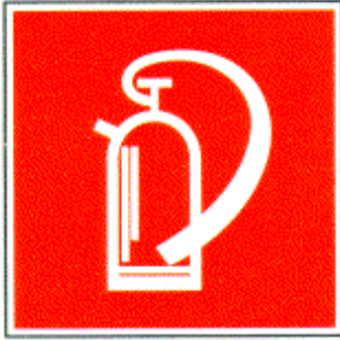
Bild 12-12: Hinweiszeichen auf Feuerlöschgeräte
