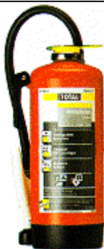
DIN EN 3 – Wasser- bzw. Schaumlöscher , z.B. 6 ltr. Inhalt bei der Brandklasse A, B mit innenliegender Treibmittelflasche, Schlagventil, Schlauch und abstellbarer Löschpistole mit Sprühstrahldüse
