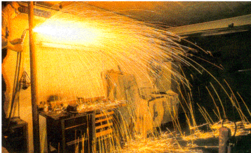
Bild 6-3: Schweißperlen können weit spritzen
