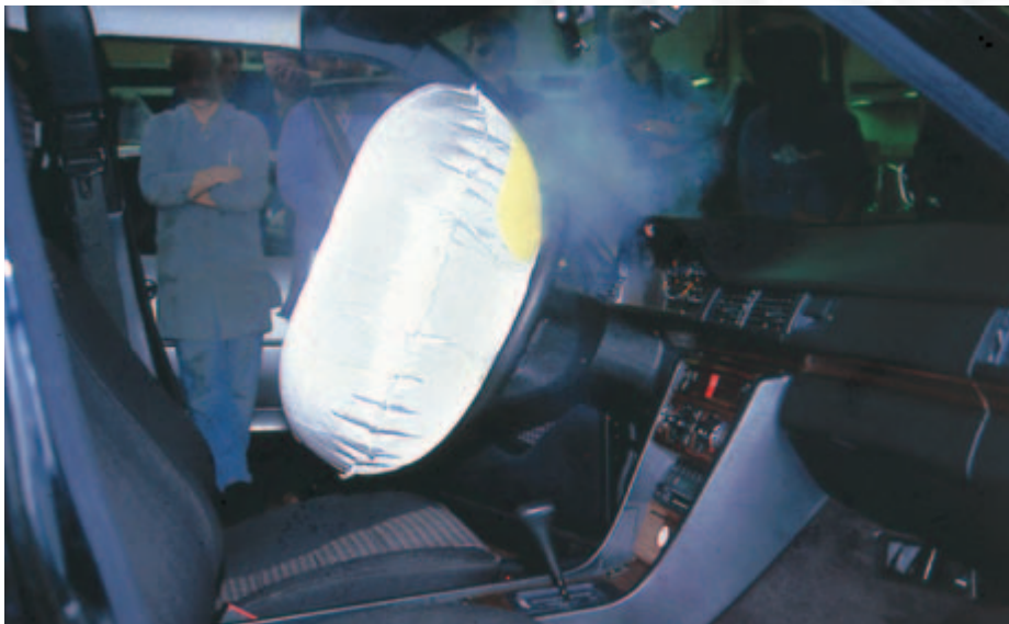
Bild 18-1: Airbag – Zündung im eingebauten Zustand
