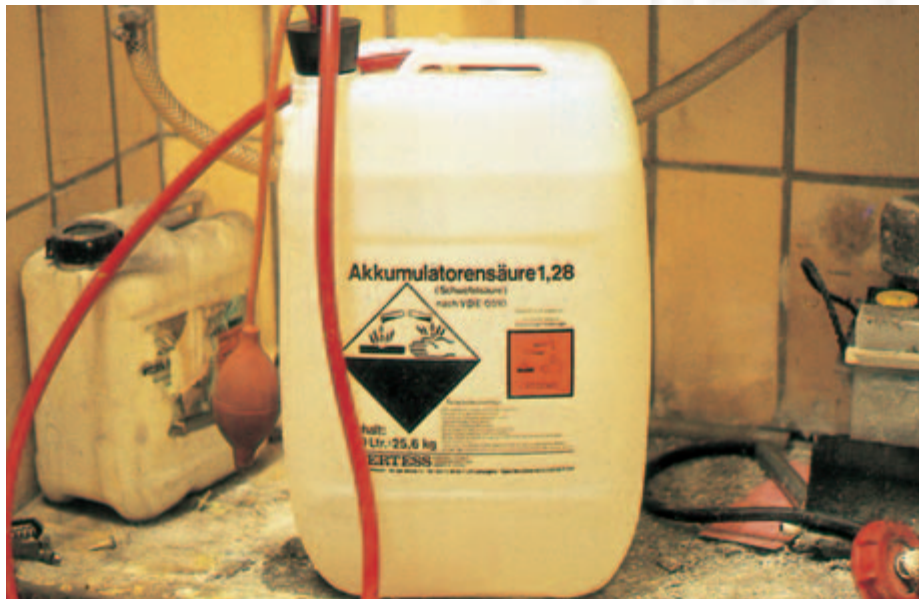
Bild 5-14: Säurefüllvorrichtung aus bruchfestem Material
