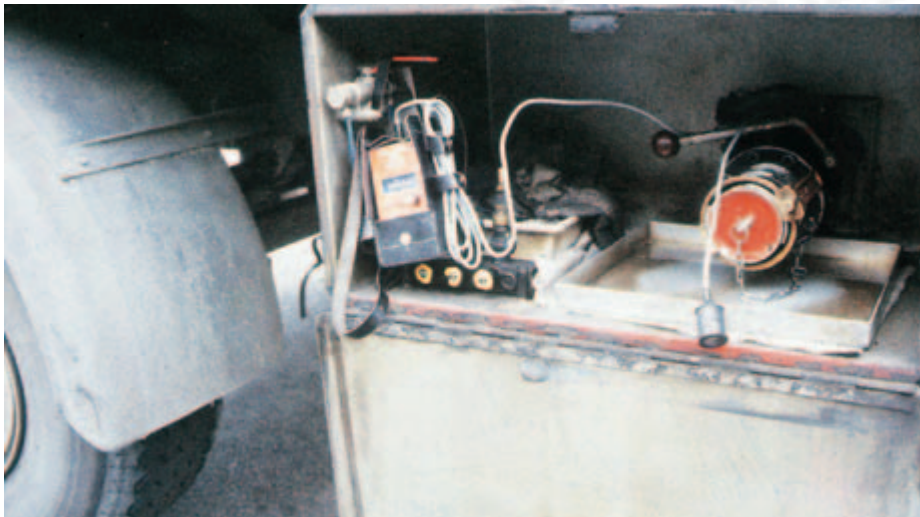
Bild 6-1: Dauerüberwachung eines Tankfahrzeuges für brennbare Flüssigkeiten oder Gase durch ein Gaswarngerät (hier angebracht am Armaturenschrank)
