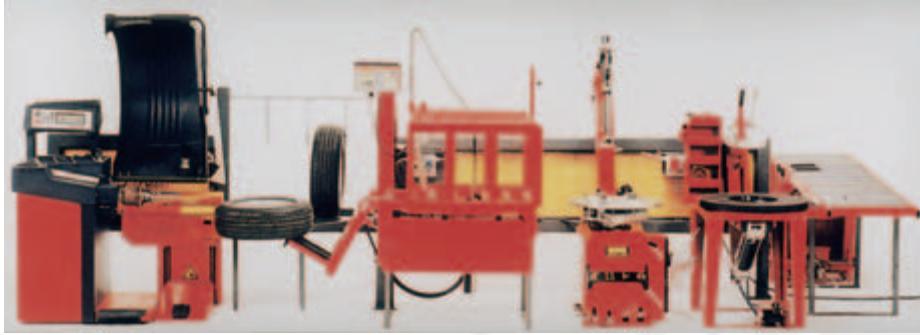
Bild 10-3: Zukunftsweisende ergonomisch gestaltete „Montagestraße“ für Pkw- und Lkw-Räder mit integrierter Befüllleinrichtung
