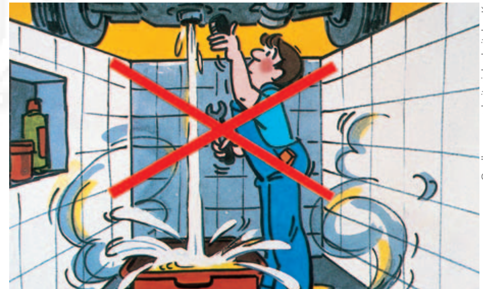
Bild 5-2: Verbotenes Ablassen von Kraftstoff in die Arbeitsgrube. Vorsicht! Explosionsgefahr durch elektrostatische Zündung
