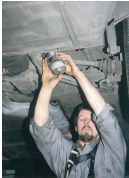
Bild 5-10: Filterausbau ohne Werkzeug
