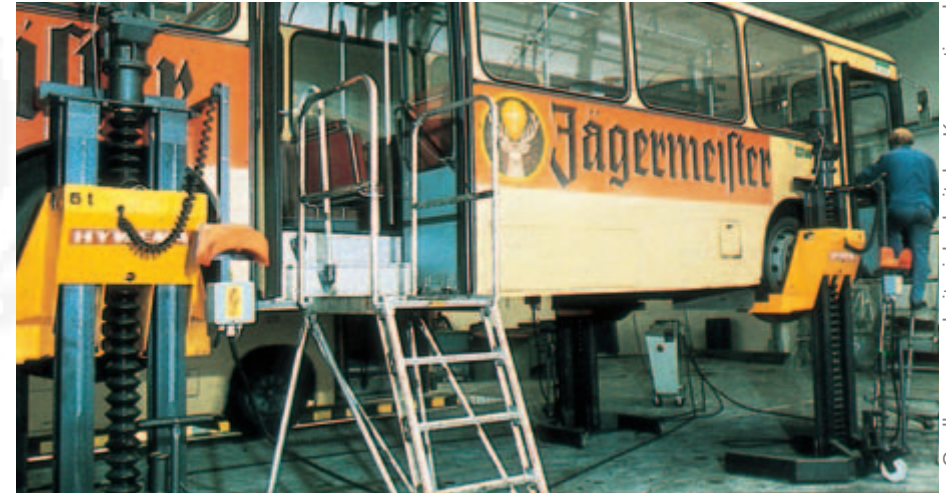
Bild 9-4: Sicherer Überstieg in ein angehobenes Fahrzeug
