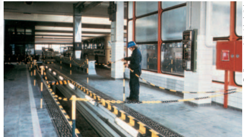
Bild 4-7: Unbenutzte Arbeitsgrube wird mit Ketten gegen Hineinstürzen gesichert
