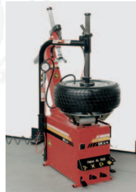
Bild 10-1: Halteeinrichtung bei kraftschlüssiger Felgeneinspannung (auch nachträglich montierbar)
