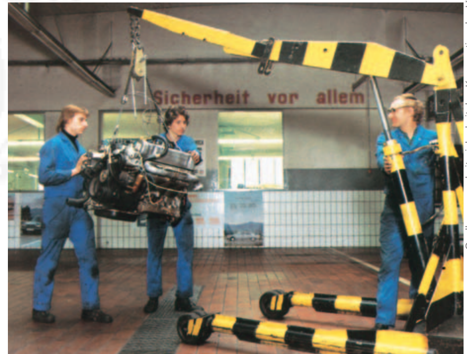
Bild 14-1: Sicherer Transport eines Motors
