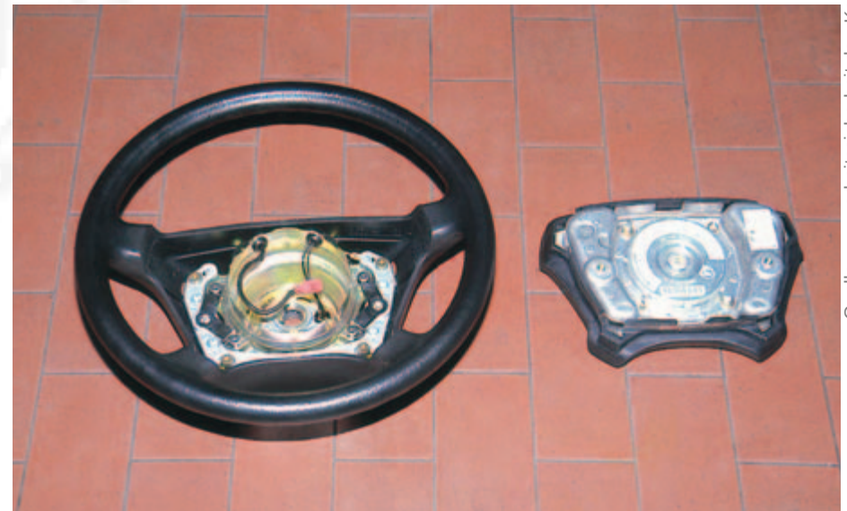
Bild 18-2: Lenkrad mit ausgebauter Airbag-Einheit
