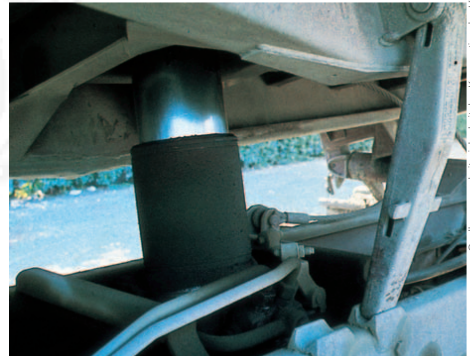
Bild 8-3: Sicher (formschlüssig) abgestützte Pritsche
