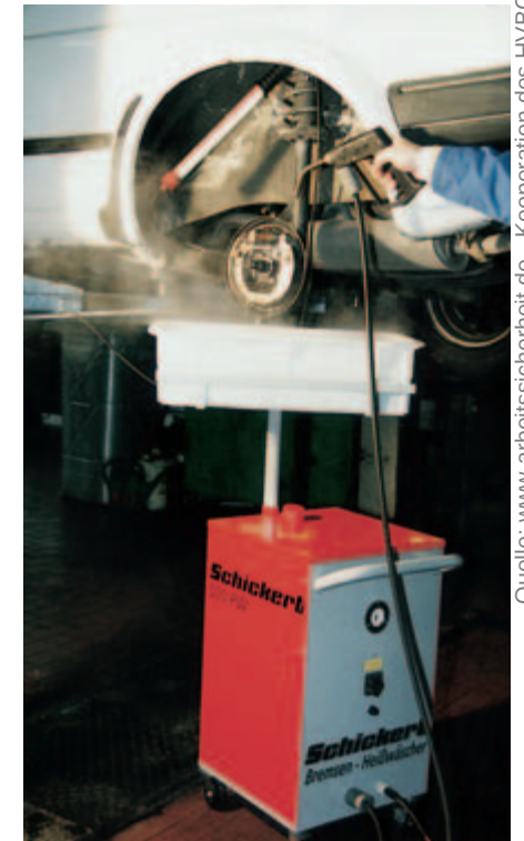
Bild 15-6: Bremsstaub entfernen mit Heißdampf-Waschgerät
