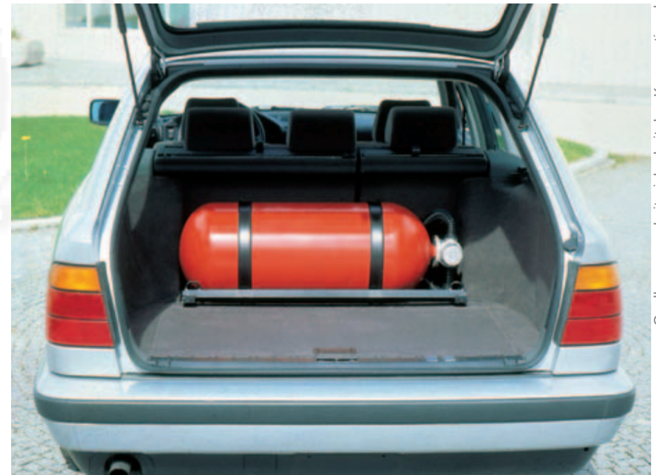
Bild 7-1: Erdgastank für bivalenten Antrieb (Quelle: BMW)
