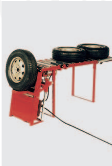
Bild 10-4: Radhebevorrichtung, automatische Funktion
