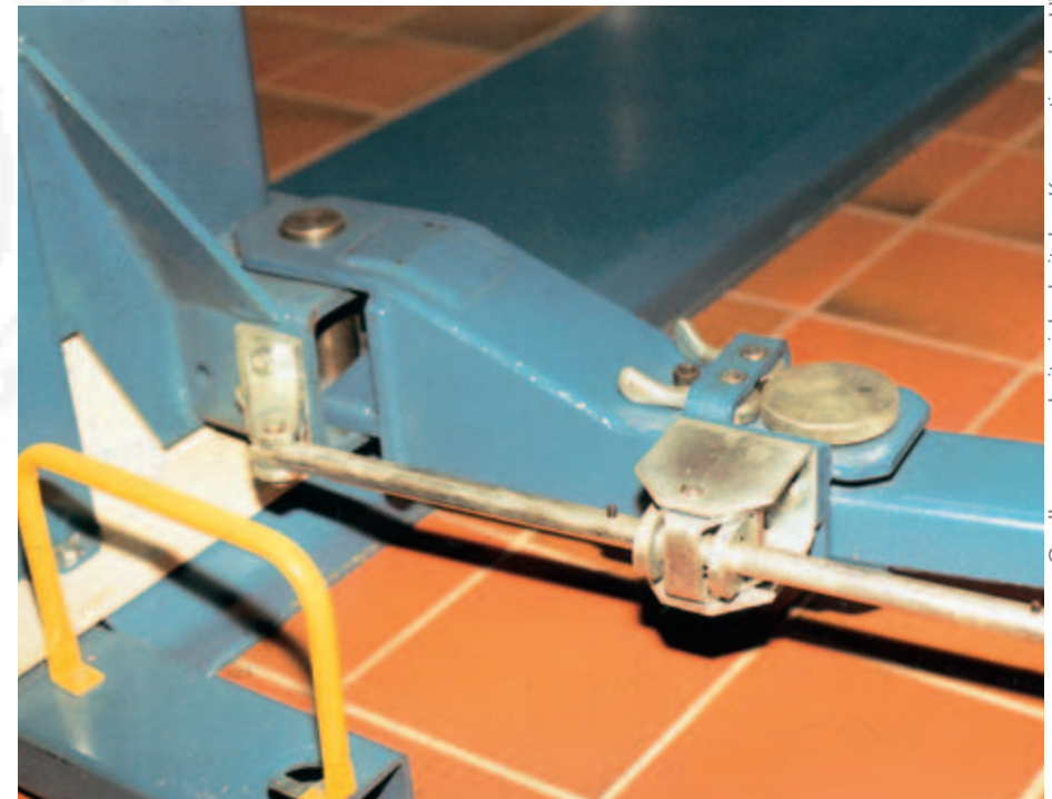
Bild 9-2: Gelenkarmsicherung an einer Fahrzeug-Hebebühne
