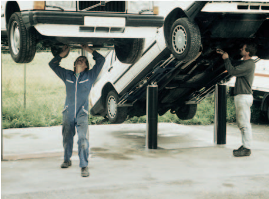
Bild 9-3: Körperhaltungsvergleich zwischen einer herkömmlichen und einer Kippbühne
