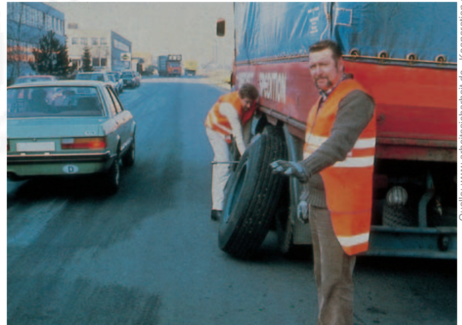
Bild 17-2: Warnkleidung bei Arbeiten im Bereich des fließenden Verkehrs
