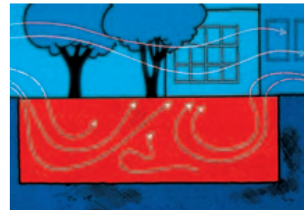
Bild 5-4: Natürliche Lüftung einer nicht abgedeckten Arbeitsgrube im Freien, unabhängig von der Grubentiefe
