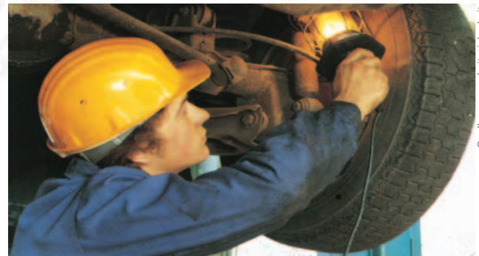
Bild 5-1: Handlampe mit Überglas und Schutzkorb
