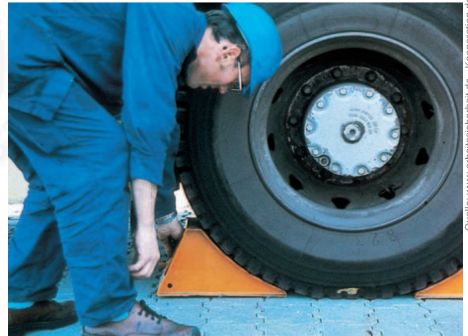
Bild 8-1: Festlegen des Fahrzeuges mit Unterlegkeilen am Rad
