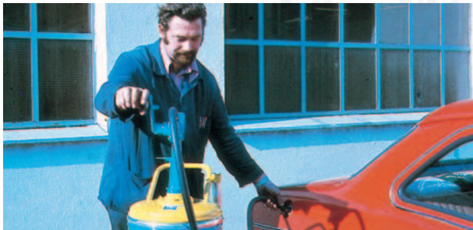
Bild 5-3: Tankentleerung mit handbetriebener Absaugpumpe, Behälter geerdet, Schlauch leitfähig
