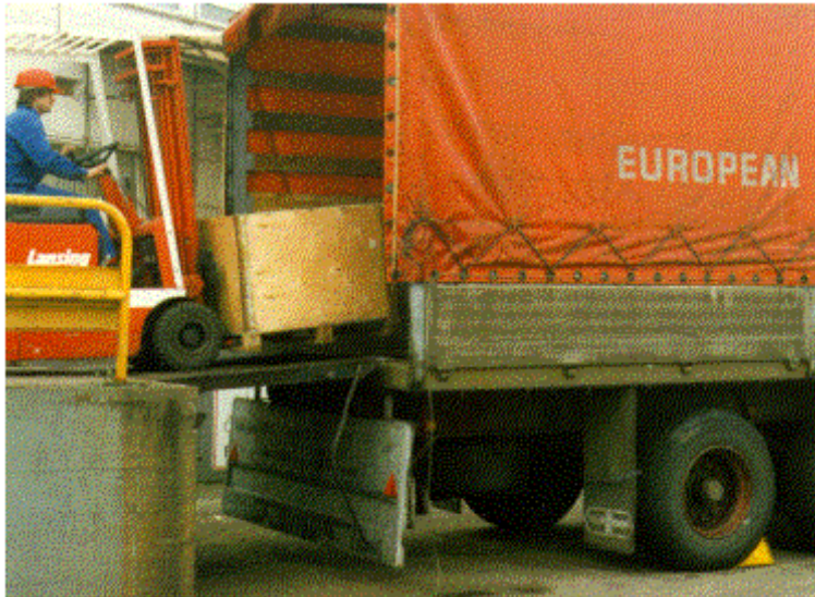
Bild 9-7: Wenn Fahrzeuge zum Be- und Entladen in Längsrichtung mit Gabelstaplern befahren werden sollen, muss das still stehende Fahrzeug durch Betätigen der Feststellbremse und Benutzen der Unterlegkeile gesichert sein
