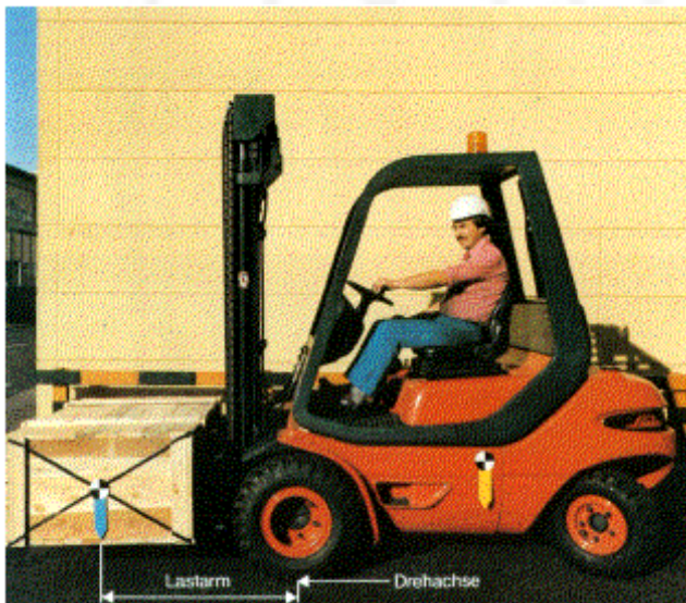
Bild 7-8: Schwerpunkte des Gabelstaplers und der Last
