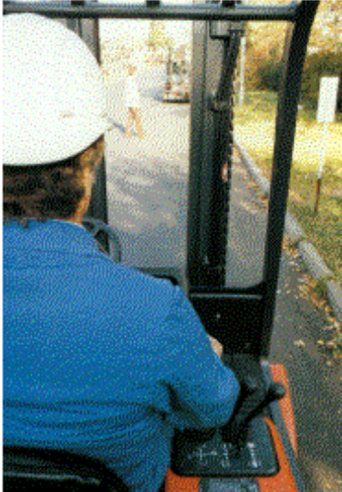
Bild 3-5: Optimal angeordnete Stellteile und bessere Sicht durch ein Freisichthubgerüst gewährleisten ein ermüdungsfreies Arbeiten
