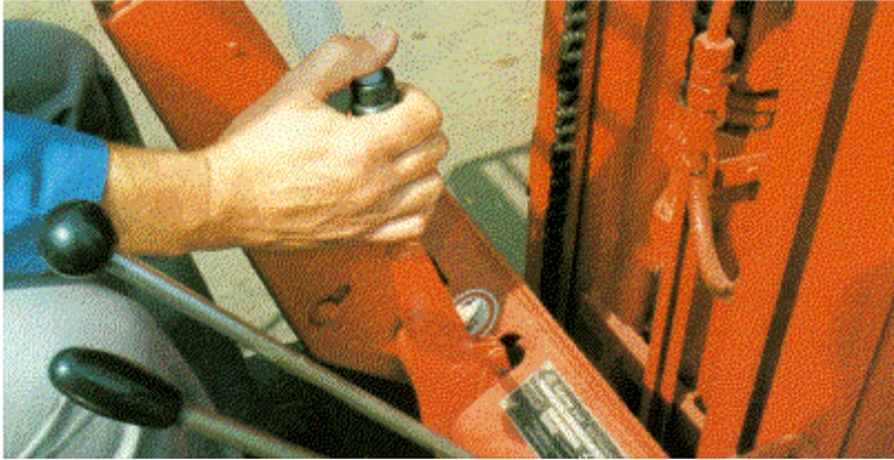
Bild 8-2: Durch Anziehen der Feststellbremse wird der Gabelstapler gegen unbeabsichtigte Bewegungen gesichert
