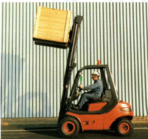
Bild 7-22: Verlagerung des Gesamtschwerpunktes bei angehobener Last
