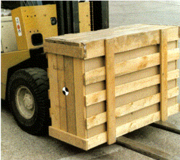
Bild 7-9: Palette möglichst von der Schmalseite aufnehmen, damit der Lastschwerpunkt immer nahe am Gabelrücken liegt
