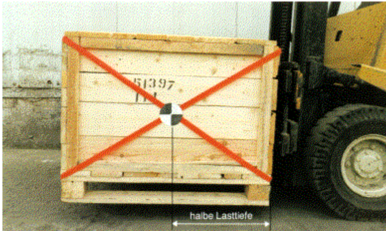
Bild 7-5: Der Schwerpunkt der Last liegt in der Regel auf halber Lasttiefe
