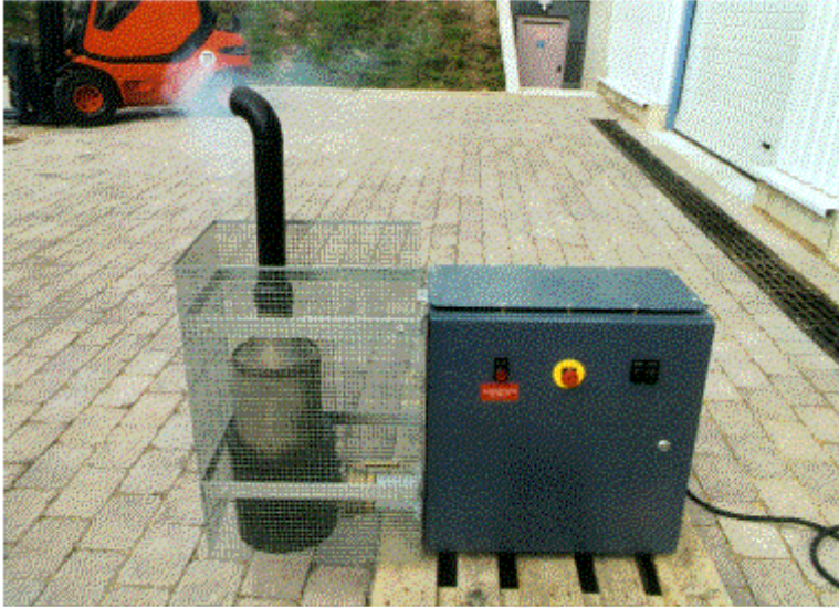
Bild 4-2: Regenerationseinrichtung für Rußfilter (Filterreinigung dauert ca. 30 Minuten)
