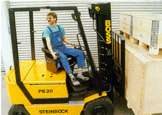
Bild 7-17: Drehbarer Fahrersitz – System "Steinbock"
