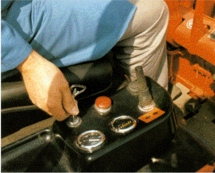
Bild 8-1: Gabelstapler erst verlassen, wenn Antrieb stillgesetzt und Schlüssel abgezogen ist
