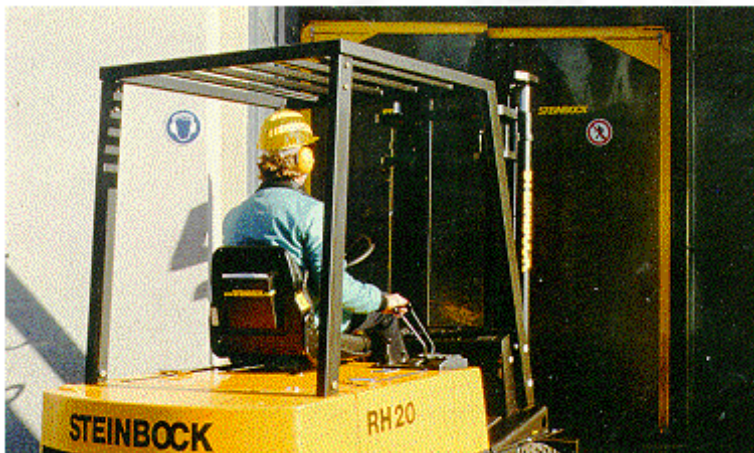
Bild 4-3: Ergonomisch ausgebildeter Fahrersitz. Fahrer trägt im Lärmbereich Gehörschutzkapsel
