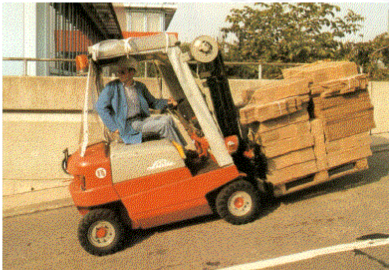
Bild 7-23: Last immer bergseitig führen
