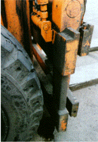
Bild 6-1: Undichte Hydraulik und Fremdkörper im Reifenprofil
