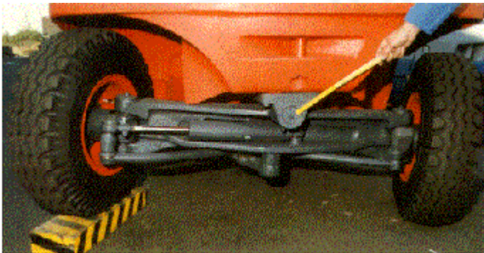
Bild 7-24: Da beim Vierrad-Gabelstapler die Hinterachse als Pendelachse ausgeführt ist, erfolgt nur eine einzige mittige Unterstützung der Last, nämlich im Lager der Pendelachse
