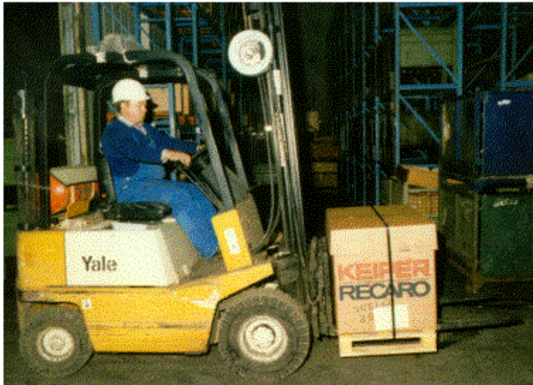
Bild 7-14: Last immer an den Gabelrücken anlegen, damit der Lastarm klein ist. Vor Fahrtbeginn den Hubmast nach hinten neigen
