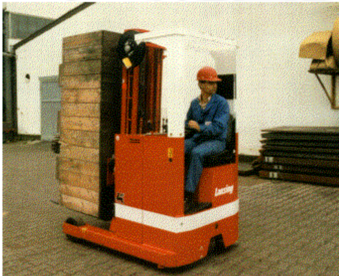
Bild 7-16: Für regelmäßiges Rückwärtsfahren geeigneter Quersitzstapler
