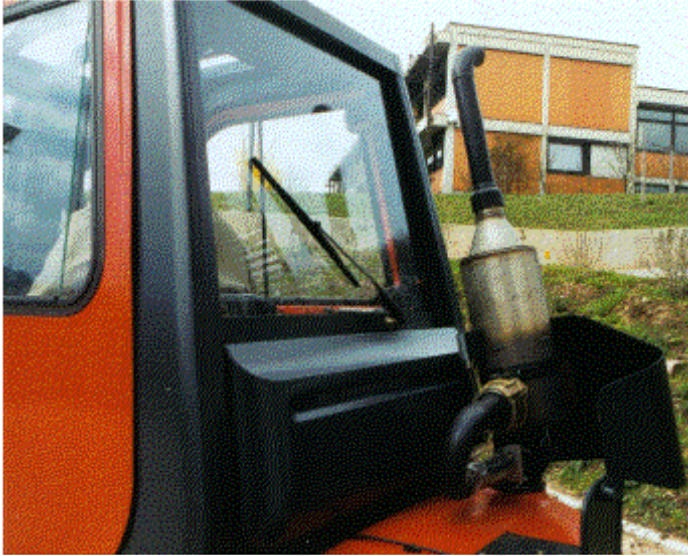
Bild 4-1: Gabelstapler mit Rußfilter (Filterkapazität reicht für ca. 8 Stunden)
