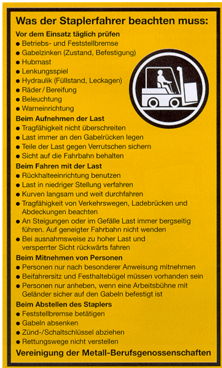
Bild 7-2: Was der Staplerfahrer beachten muss (Kurzinfo als Aufkleber für den Stapler)
