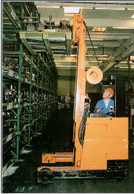
Bild 7-15: Nur zum Auf- und Absetzen mit hochgestellter Last verfahren. Hubgerüst nur über der Stapelfläche nach vorne neigen
