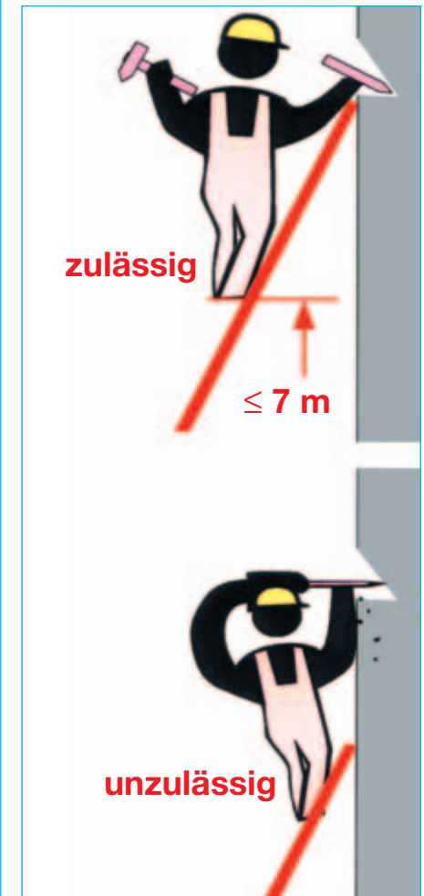
Bild 2-3: Arbeiten von der Leiter aus
