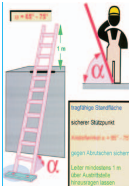
Bild 2-4: Anlegewinkel und Überstand
